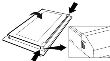
2. Tirez vers vous le composant en plastique fixé sur la partie supérieure de la porte avant en poussant simultanément sur les points de pression des deux côtés du composant et retirez-le.
