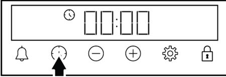
3 لضبط وقت الطهي بسرعة، يمكنك لمس المفتاح (+) مباشرة لضبط وقت الطهي على 30 دقيقة بعد ضبط الوظيفة ودرجة الحرارة ثم استخدم مفاتيح (+/-) لتغيير الوقت.
