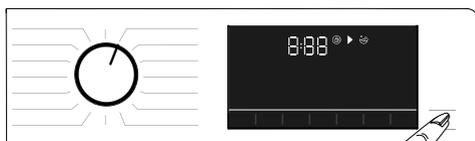
4 Die Programmfolgeanzeigen im Display zeigen den aktuellen Programmschritt.
