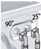
Schließen Sie die mit der Maschine gelieferten Spezialwasserzulaufschläuche an die Wasserzulaufe des Gerätes an. Der rote Schlauch (links) dient als Warmwassereinlass (maximal 90 °C), der blaue Schlauch (rechts) als Kaltwassereinlass (maximal 25 °C). Stellen Sie sicher, dass Heiß- und Kaltwasserhähne bei Installation des Produktes richtig angeschlossen werden. Bei fehlerhaftem Anschluss kommt Ihre Wäsche am Ende des Waschvorgangs eventuell heiß aus der Maschine und verschleißt schneller.
