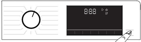
Falls der Wasserstand in der Maschine bei Betätigung der **Start/Pause**-Taste zu hoch ist, zeigt das Display an, dass die Gerätetür verriegelt ist.
