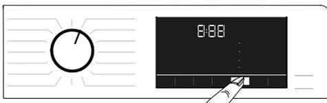
Drücken Sie bei Auswahl eines neuen Waschprogramms zur Einstellung der für dieses Programm geeigneten Trocknungsoption die Zusatzfunktionstaste.
