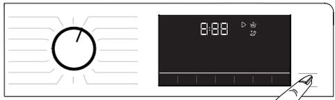
Halten Sie die Maschine durch Drücken der **Start/Pause**-Taste an.
