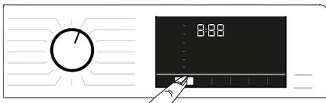
Sobald Sie ein neues Programm auswählen, wird die für das ausgewählte Programm empfohlene **Schleuderdrehzahl** angezeigt.
