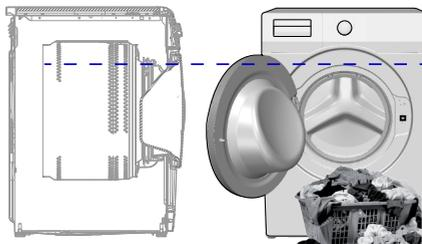
Im Waschprogramm für 5 kg und Trocknungsprogramm für 5 sollten Sie die Maschine für optimale Trocknungsleistung bis zum oben gezeigten Füllstand beladen (Sie sehen den Pfeil, wenn Sie die Ladetür öffnen).
