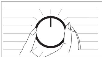
Das Programm wird abgebrochen, falls der Programmauswahlknopf auf ein anderes Programm eingestellt oder die Maschine mit dieser Taste aus- und wieder eingeschaltet wird.
