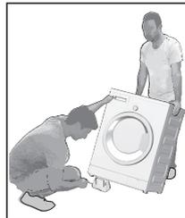
Zum Entfernen der Transportstabilisatoren neigen Sie die Maschine etwas nach hinten. Entfernen Sie die am Band befestigten Stabilisatoren.
