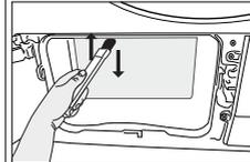
Reinigen Sie die Faser auf der Metalloberfläche des Kondensators mit einem feuchten Tuch oder der Bürste am Luftleitblech nach oben und unten. Reinigen Sie nicht von links nach rechts, da dies die Metallplatten des Kondensators beschädigen kann. Sie können zur Reinigung auch einen Staubsauger mit Bürste verwenden. Wenn der Staubsauger keine Bürste hat, sollte er nicht zur Reinigung des Kondensators verwendet werden.
