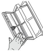
Wenn sich auf der Oberfläche des Filtertuchs eine Schicht bildet, die zu Verstopfungen führen kann, entfernen Sie diese mit der Hand oder der Bürste am Luftleitblech.
