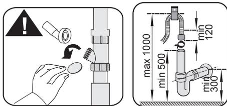
**i** Der Wasserablauf sollte direkt in die Kanalisation führen; das Abwasser darf nicht in das Oberflächen- oder Grundwasser gelangen.
