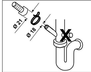
Wasserablaufschläuche mit einer Länge von mehr als 4 m können zu Verschmutzungen führen. Achten Sie darauf, dass der Wasserablaufschlauch auf dem Weg zum Ablauf nicht geknickt oder stark gebogen wird. Fixieren Sie den Wasserablaufschlauch so am Ablauf, dass er sich im laufenden Betrieb des Gerätes keinesfalls lösen kann.
