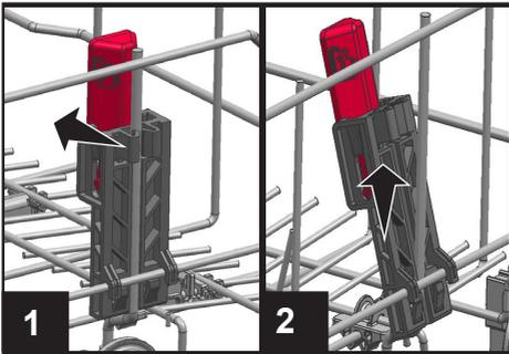
**i** Die TrayWash müssen gemäß den Abbildungen 1 und 2 für Leistungstests entfernt werden, die gemäß den Normen durchgeführt werden müssen.
