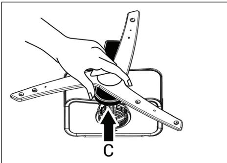
Zum Ausbauen und Reinigen der unteren Sprüharmbaugruppe halten Sie sie an den in der Abbildung gezeigten Punkte (C) mit einer Hand fest und ziehen Sie sie nach oben. Montieren Sie die Teile nach der
