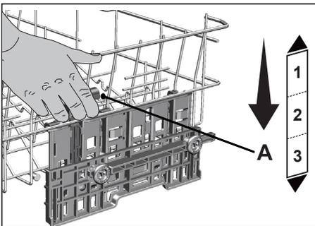
1. Um den Korb anzuheben, halten Sie die Drähte des Korbs und ziehen Sie den Korb mit beiden Händen nach oben, während sich der Korb in der untersten Position befindet (B).
