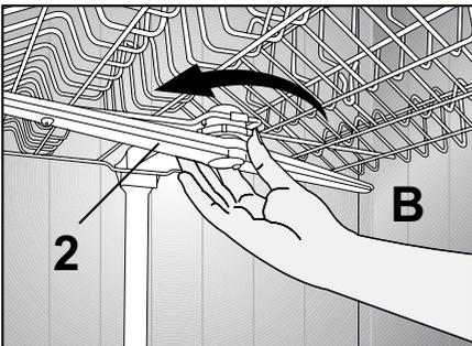
3. Lösen Sie die Befestigungsschraube des oberen Sprüharms und ziehen den Sprüharm ab (**B**).
