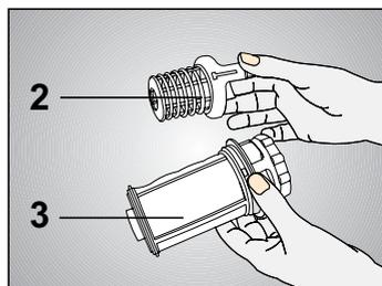
4. Drücken Sie auf die beiden Zungen des Grobfilters und nehmen Sie den Microfilter heraus (C).
