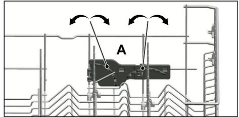
**i** Falls Sie den Halter an den Spitzen fassen und in eine horizontale Position bringen, kann sich der Halter verbiegen. Fassen Sie daher immer etwas tiefer an, wenn Sie den Halter in eine horizontale oder vertikale Position bringen.
