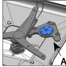
Die Wash-Spüleinheit (A) unter dem unteren Sprüharm ermöglicht ein besseres Reinigen für Ihre stark verschmutzte Flaschen und Geschirteile, die sich gemäß dem
