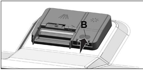
4. Falls nach dem Spülen Flecken am Geschirr verbleiben, stellen Sie eine höhere Stufe ein. Sollte eine bläuliche Färbung nach dem Abwischen des Geschirrs von Hand zurückbleiben, wählen Sie eine niedrigere Stufe. Ihr Gerät ist ab Werk auf Position 3 voreingestellt.
