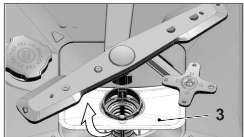
3. Drücken Sie die beiden Sperren am Grobfilter nach innen, lösen Sie den Grobfilter von der Baugruppe.
