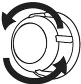
3. Wenn Ihre Ofenbeleuchtung dem Typ A in der nachstehenden Abbildung entspricht, drehen Sie das Leuchtmittel wie in der Abbildung gezeigt heraus, setzen
