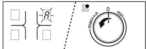
2. Drehen Sie den Kochzonenknopf zum Einstellen der Temperaturstufe im Uhrzeigersinn (im Beispiel wird die Stufe 7 ausgewählt).
