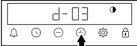
3. Berühren Sie die Taste
