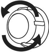
3. Se la lampada del forno è del tipo (A), come mostrato in figura, ruotare la lampada come mostrato in figura e sostituirla con una nuova. Se è un modello del tipo (B), estrarla come mostrato in figura e sostituirla con una nuova.
