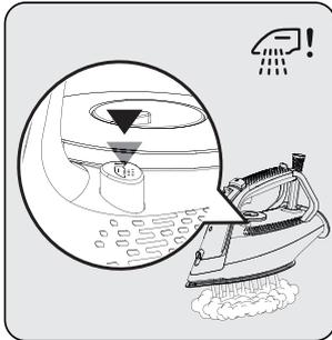
Așezați aparatul orizontal pe chiuvetă și agitați fierul apăsând butonul "!" anti-calcar (7). Continuați până când se termină apa din rezervorul de apă (8). Când ați terminat, eliberați butonul anti-calcar (7).
