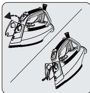
Otvorite otvor za punjenje vode (2) i ispuštite preostalu vodu iz rezervoara za vodu (8) naginjanjem uređaja napred.
