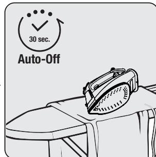
Wenn Sie das Gerät 30 Sekunden lang nicht in seitlicher Position (rechts oder links) bewegen, wird es automatisch ausgeschaltet.
