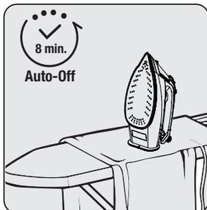
Ako uređaj ne pomerate 8 minuta dok je u vertikalnom položaju, automatski će se isključiti.
