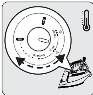
Setați temperatura corectă folosind butonul de reglare a temperaturii (6).
