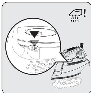
Postaw urządzenie poziomo na zlew i potrząśnij żelazkiem, naciskając przycisk odkamieniania "☁️!" (7). Powtarzaj tak długo aż skończy się woda w zbiorniku (8). Po zakończeniu zwolnij przycisk odkamieniania (7).
