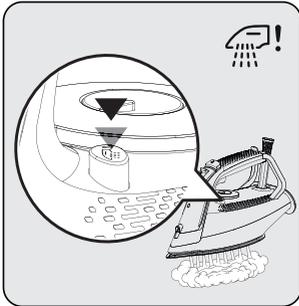
Stellen Sie das Gerät horizontal auf die Spüle und schütteln Sie das Bügeleisen durch Drücken der Entkalkungstaste "☁️!", (7). Fahren Sie fort, bis das Wasser im Wassertank (8) ausgeht. Wenn Sie fertig sind, lassen Sie die Entkalkungstaste (7) los.
