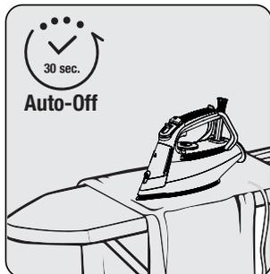
Wenn Sie das Gerät in horizontaler Position etwa 30 Sekunden lang nicht bewegen, wird es automatisch ausgeschaltet.
