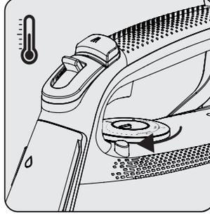
Sıcaklık ayar düğmesini (6) çevirerek sıcaklık ayarını "MAX" konumuna getirin ve termostat ışığı (10) sönene kadar bekleyin.
