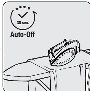
Si vous ne déplacez pas l'appareil dans les 30 secondes quand il est en position latérale (droite ou gauche), il s'éteint automatiquement.
