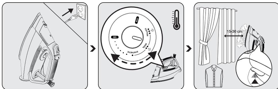
Napunite vodom rezervoar za vodu (8) (videti 3.3). Uređaj postavite u uspravan položaj i uključite.
