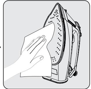
Wischen Sie alle Rückstände außerhalb des Geräts und auf der Grundplatte (9) mit einem feuchten Tuch und gegebenenfalls einem leichten, nicht scheuernden flüssigen Reinigungsmittel ab.
