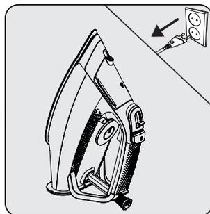
Przed przystąpieniem do czyszczenia odłącz urządzenie od zasilania.
