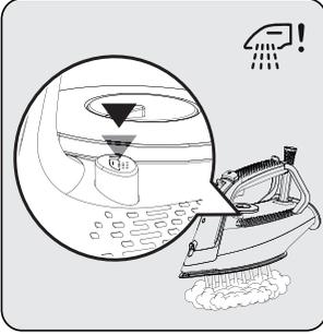
Cihazı yatay şekilde lavabo üzerine getirin ve "!" kireç temizleme düğmesine (7) basarak ütüyü sallayın. Su haznesindeki (8) su bitene kadar işleme devam edin. İşlem bittiğinde kireç temizleme düğmesini (7) bırakın.
