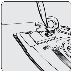
Napunite vodu do linije MAX, držeći uređaj u blago vertikalnom položaju.
