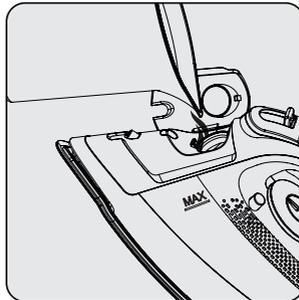
Füllen Sie das Wasser bis zur MAX-Linie und halten Sie das Gerät in einer leicht vertikalen Position.
