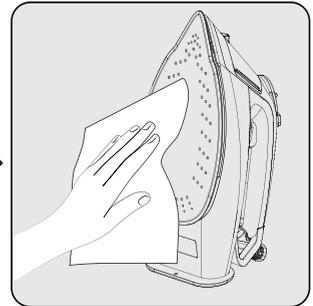
Ștergeți orice resturi de pe exteriorul aparatului și de pe talpă (9) cu o lavetă umedă și un agent de curățare slab, neabraziv, dacă este necesar.
