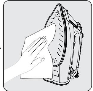
Ștergeți orice resturi de pe exteriorul aparatului și de pe talpă (9) cu o lavetă umedă și un agent de curățare slab, neabraziv, dacă este necesar.
