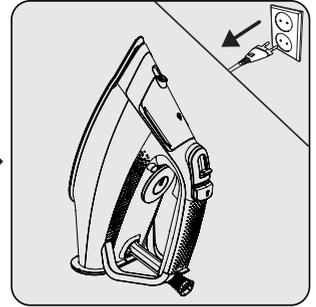
Débranchez l'appareil avant de procéder au nettoyage.
