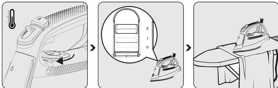
Setați temperatura corectă folosind butonul de reglare a temperaturii (6).
