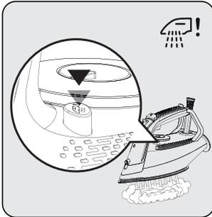
Positionnez l'appareil horizontalement sur l'évier et secouez le fer à repasser en appuyant sur la touche de détartrage "☼!" (7). Continuez jusqu'à ce qu'il n'y ait plus d'eau dans le réservoir (8). Une fois terminé, libérez le bouton de détartrage (7).
