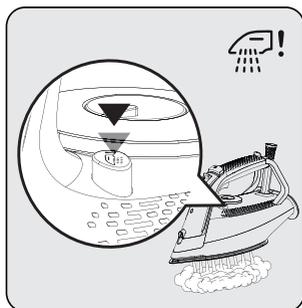
Postavite uređaj vodoravno na sudoperu i protresite peglu pritiskom na dugme "!" za uklanjanje kamenca (7). Nastavite dok se rezervoar za vodu (8) ne isprazni. Po završetku otpustite dugme za uklanjanje kamenca (7).
