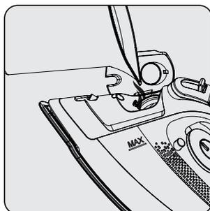
Remplissez l'eau jusqu'au niveau de la ligne MAX, en tenant l'appareil en position légèrement verticale.
