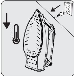
Débranchez l'appareil avant de procéder au nettoyage. Patientez afin de permettre à l'appareil de refroidir complètement.
