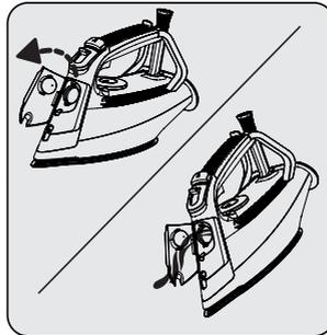
Ouvrez le bouchon de remplissage d'eau (2), puis videz l'eau restante du réservoir d'eau (8) en basculant l'appareil vers l'avant.
