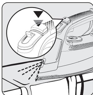
Apăsați butonul de pulverizare a apei (4) și continuați să călcați.
