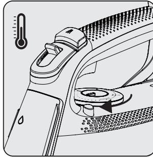
Setați buton pentru reglarea temperaturii (6) la poziția "MAX" și așteptați până când se stinge lampa termostatului (10).
