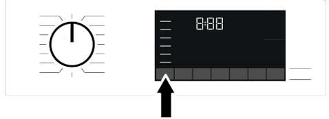
Sobald Sie ein neues Programm auswäh- len, wird die für das jeweilige Programm empfohlene Waschtemperatur in der Tem- peraturanzeige angezeigt. Möglicherweise ist die empfohlene Temperatur nicht die Maximaltemperatur, die beim aktuellen Pro- gramm ausgewählt werden kann. Drücken Sie zum Ändern der Temperatur die Temperatureinstelltaste. Die Tempera- tur wird Schritt für Schritt vermindert.
