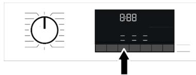
Wählen Sie die gewünschten Hilfsfunktionen aus, bevor Sie das Programm starten. Bei Auswahl eines Programms leuchten die Symbole der kompatiblen Zusatzfunktions-symbole auf.
