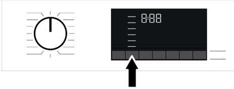
Nachdem ein Programm ausgewählt wurde, wird die empfohlene Schleuderdrehzahl des gewählten Programms in der Anzeige Schleuderdrehzahl dargestellt. Möglicherweise ist die empfohlene Schleuderdrehzahl nicht die Maximalschleuderdrehzahl, die beim aktuellen Programm ausgewählt werden kann.
