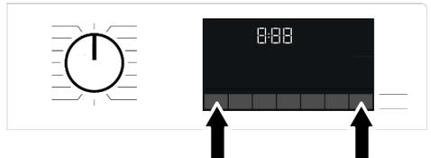
3. Wenn sich das Gerät im HomeWhiz-Einrichtungsmodus befindet, sehen Sie eine Animation am Display und das Bluetooth-Symbol blinkt, bis Ihre Maschine mit dem Smart-Gerät gekoppelt wurde. In diesem Modus ist am Gerät nur noch der Programmknopf aktiv. Andere Tasten werden inaktiv sein.
