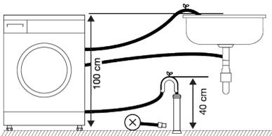
4. Damit kein verschmutztes Wasser in das Produkt zurücklaufen kann und um der Maschine das Abpumpen zu erleichtern, darf das Ende des Schlauches nur maximal 15 cm tief in den Abfluss eingeführt werden.
