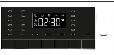
Si le niveau d'eau dans la machine est convenable, lorsque vous appuyez sur le bouton **Départ/Pause**, le voyant « Porte de chargement verrouillée » s'éteint à l'écran. Si le niveau d'eau dans la machine n'est pas adapté lorsque vous appuyez sur le bouton **Départ / Pause**, l'écran indiquera que la porte de chargement est verrouillée.
