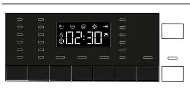
Le programme est annulé lorsque la machine est éteinte et rallumée. Appuyez sur le bouton **Marche / Arrêt** et maintenez-le enfoncé pendant 3 secondes. Lorsque le compte à rebours « 3-2-1 » disparaît de l'écran, la machine s'éteint.
