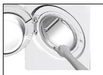
Après chaque lavage et séchage, veillez à ce qu'aucun corps étranger ne soit resté dans le tambour. Si les orifices situés sur le soufflet présenté dans le schéma sont obstrués, débloquez-les à l'aide d'un cure-dent.
