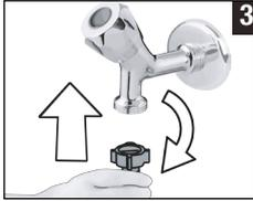
**3** Ouvrez complètement les robinets après avoir raccordé les tuyaux pour vérifier s'il n'y a pas de fuite d'eau par les points de raccordement.
