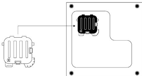
Inclinez légèrement la machine vers l'arrière. Posez les languettes du couvercle A contre le panneau inférieur. Terminez l'assemblage en tournant le couvercle.
