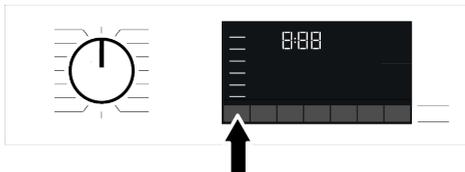
Chaque fois qu'un nouveau programme est sélectionné, la température recommandée pour ledit programme apparaît sur l'indicateur de température. Il est possible que la température recommandée ne soit pas la température maximale pouvant être sélectionnée pour le programme en cours.
