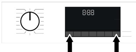
3. Lorsque l'appareil est en mode configuration HomeWhiz, une animation apparaîtra à l'écran et l'icône du Bluetooth clignotera jusqu'à ce que la machine soit appariée avec le périphérique intelligent.
