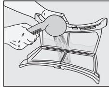
Im Laufe der Zeit können sich die Poren des Filters zusetzen. Zum Entfernen von Rückständen waschen Sie den Fusselfilter mit warmem Wasser aus. Lassen Sie den Fusselfilter vollständig trocknen, bevor Sie ihn wieder einsetzen.
