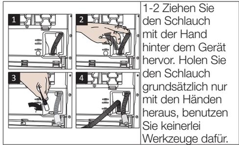
1-2 Ziehen Sie den Schlauch mit der Hand hinter dem Gerät hervor. Holen Sie den Schlauch grundsätzlich nur mit den Händen heraus, benutzen Sie keinerlei Werkzeuge dafür.
