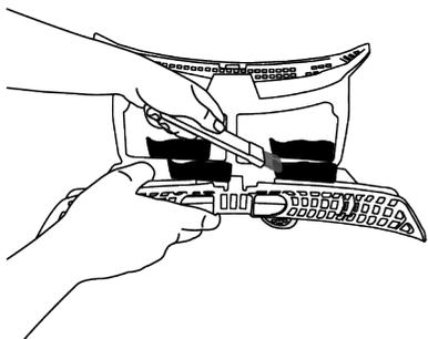
5. Reinigen Sie beide Filter unter fließendem Wasser in umgekehrter Richtung der Faseransammlung mit der Hand oder mit einer weichen Bürste. Trocknen Sie die Filter, bevor Sie sie wieder einsetzen.
