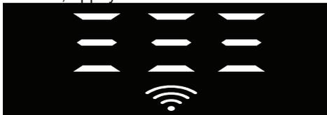
En cas de connexion sans fil activée, le voyant de connexion Wi-Fi est allumé en permanence, en cas de connexion sans fil désactivée, le voyant de connexion Wi-Fi clignote à intervalles rapprochés. Il suffit d'appuyer sur le bouton de la télécommande pendant que la fonction est activée pour que la fonction HomeWhiz soit désactivée, l'indicateur du produit passe en affichage temps de retard/temps de programme. En position éteinte, le voyant du bouton HomeWhiz s'éteint.
