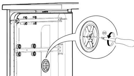
Le réglage de l'entretien de la verrerie permet de modifier la dureté de l'eau de lavage pré-adoucie dans le lave-vaisselle. Effectuez le réglage en fonction de la dureté de l'eau. Effectuez le réglage à l'aide d'un tour-
