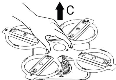
Pour démonter et nettoyer le groupe d'hélices inférieur, saisissez-le d'une main par les points (C) indiqués sur la figure et tirez-le vers le haut. Après le nettoyage, remettez le groupe d'hélices en place en suivant les mêmes étapes dans le sens inverse. (Selon le modèle)
