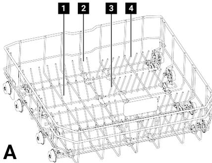
Au besoin, vous pouvez créer des espaces plus grands en pliant chaque pièce individuellement ou toutes ensemble. Soulevez les fils vers le haut pour les remettre en position verticale. Les fils pliables s'enclenchent à nouveau dans le loquet (C).
