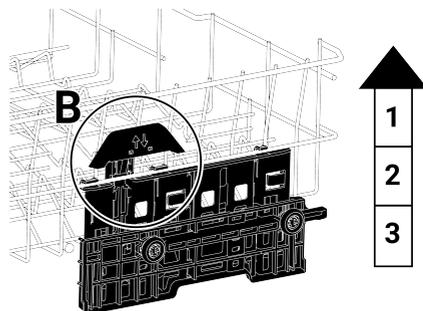
**i** Le mécanisme de mouvement peut ne pas fonctionner correctement lorsque le panier supérieur est surchargé ou lorsque la charge est déséquilibrée. Et il peut aller à la prochaine position inférieure dans des conditions plus lourdes.
