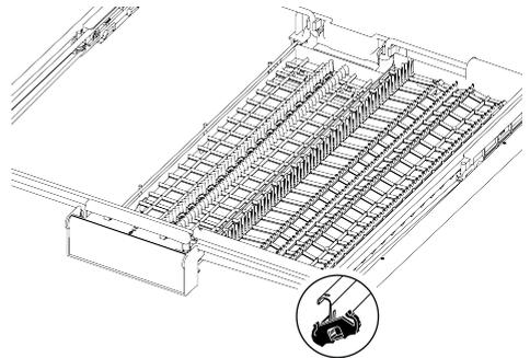
Dans les modèles à mouvement partiel, lorsque le bras (1) de la poignée est poussé, le plateau de la partie centrale du panier descend en position basse ; le système est déverrouillé et les plateaux latéraux droit et gauche peuvent être déplacés librement. Le déplacement des plateaux latéraux libère de l'espace et permet de charger les plats longs dans le panier supérieur.
