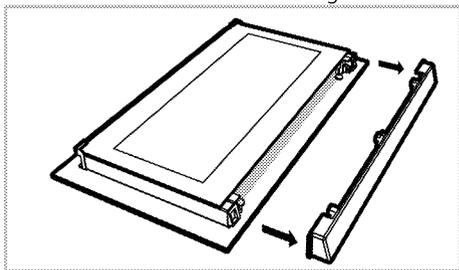
3. Kao što je prikazano na slici, malo podignite staklenu ploču s unutrašnje strane (1) prema „A“ a zatim je izvadite povlačenjem prema „B“.
