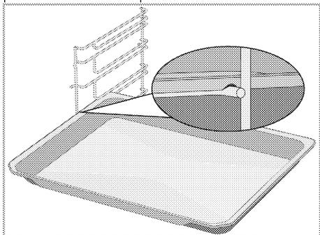
Mise en place appropriée de la grille métallique et de la lèche-frite sur les
