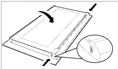
2. Povucite plastični deo pričvršćen na gornjem delu ulaznih vrata prema sebi istovremeno pritiskom na tačke pritiska sa obe strane dela i izvadite ga.
