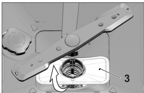
3. Pulse los dos trinquetes del filtro grueso hacia adentro y separe el filtro grueso del montaje.
