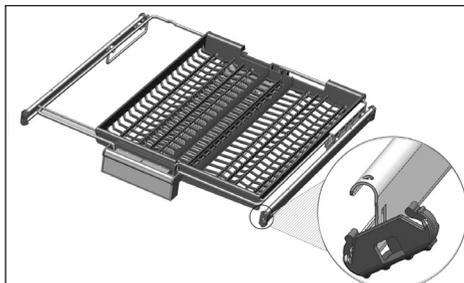
Cuando la bandeja central está en la posición más baja, puede cargar los objetos largos/altos como tazas de café, cucharas, etc. en la bandeja. Cuando las bandejas laterales se apoyan sobre dos paredes laterales, se puede tirar del asa para permitir que la bandeja central suba y el sistema pueda bloquearse.
