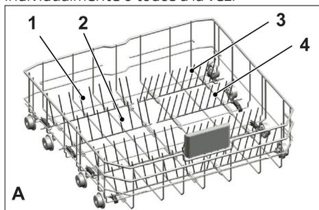
Para poner las púas abatibles en posición horizontal, cójalas del medio y empujelas hacia la dirección de las flechas (B). Para poner las púas en posición vertical, simplemente levántelas. Los canastos de alambre abatibles encajarán en el pestillo de nuevo (C).
