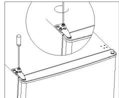
14. Klik de afdekking van het scharnier en de afdekking van de opening vast bovenaan op het apparaat.
