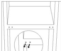
11 Stellen Sie das Gerät auf und legen Sie die Tür auf das untere Scharnier. Stellen Sie sicher, dass der untere Scharnierkern in die Türöffnung eingesetzt ist. Bewegen Sie dann die Scharnierlochabdeckung der unteren Tür von der linken Seite auf die rechte Seite.
