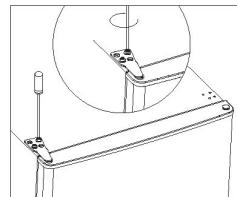
14. Bater na tampa da dobradiça e na tampa do orifício na parte superior da unidade.
