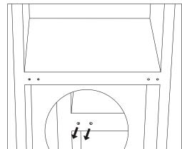
7. Поставете го задниот дел од кабинетот на мека површина. Потоа одвртете ја долната шарка и ногарка за израмнување.
