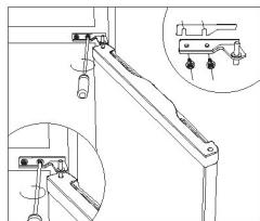
6. Mover as duas tampas do orifício central da esquerda para a direita.
