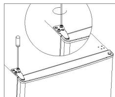
14. Zatrzaśnij pokrywę zawiasu i pokrywę otworu w górnej części urządzenia.
