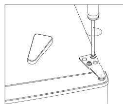
3. Odstranite pokrov s ploskim izvijačem.
