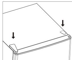
15. Odvojite zaptivke vrata frižidera i zamrzivača, a zatim ih pričvrstite nakon rotiranja.
