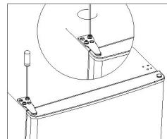
14. Fije la tapa de la bisagra y la tapa del hueco en la parte superior del aparato.
