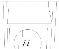
11. Dvignite napravo in postavite vrata na spodnji tečaj.
