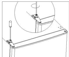
14. Frappez dans le couvercle de la charnière et dans le couvercle du trou au-dessus de l'appareil.
