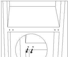
11. Redressez l'appareil et placez la porte sur la charnière inférieure. Assurez-vous que le noyau de la charnière inférieure est inséré dans le trou de la porte. Ensuite, déplacez le couvercle du trou de charnière de la porte inférieure de la gauche vers la droite.
