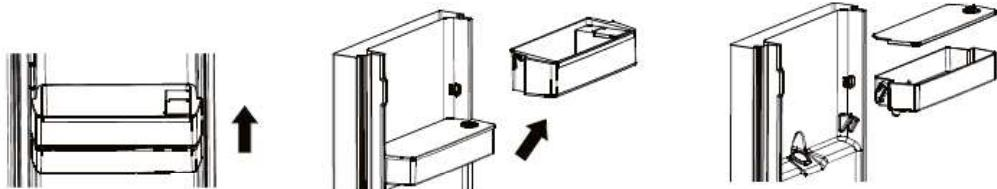
2. Plaats na het reinigen het waterreservoir, de afdekking en het reservoirbalkon weer terug zoals hieronder staat afgebeeld.
