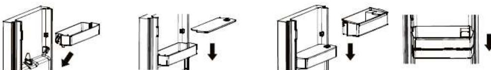
3. Reinigen Sie das Spenderhebel an der Außenseite der Kühlzentraltür.
