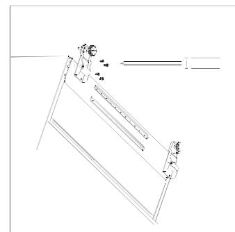
6. Depois de posicionado o aparelho, instale as portas pelo processo inverso.
