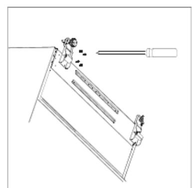
6. Paigutage seade kohale ja paigaldage uksed vastupidises järjekorras nende eemaldamisele.
