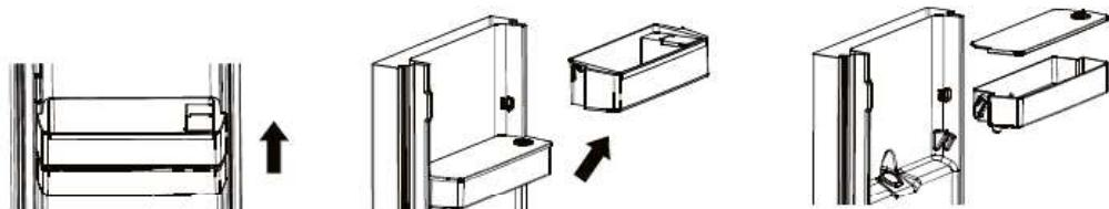
2. Po čiščenju ponovno namestite posodo za vodo, pokrov in polico za posodo, kot prikazuje spodnji postopek.
