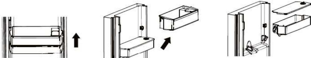
2. Po wyczyszczeniu należy ponownie ustawić zbiornik wody, pokrywę i balkon zbiornika w sposób opisany poniżej.
