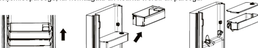
2. Pēc tīrišanas ievietojiet ūdens tvertni, pārsegu un plauktu atpakaļ.
