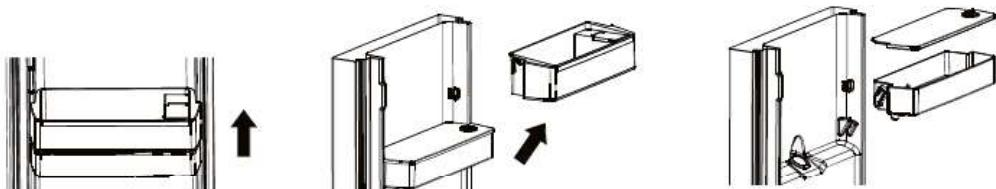
2. Après nettoyage, repositionnez le réservoir d'eau, le couvercle et le bloc du réservoir comme illustré ci-dessous.
