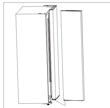
5. Schroef de onderste scharnieren los.
