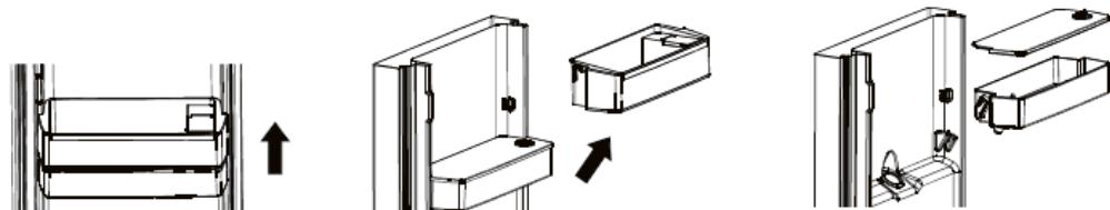
2. Una vez limpios, vuelva a instalar el depósito, la cubierta y el soporte, invirtiendo el orden del procedimiento inicial.
