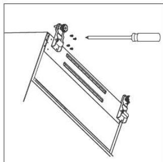
6. Po ustawieniu urządzenia zamontuj drzwi w odwrotnej kolejności.
