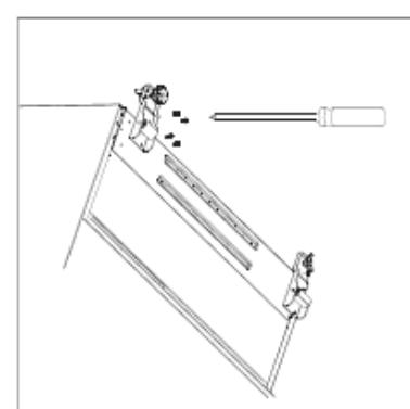
6. Po umiestnení spotrebiča namontujte dvierka späť opačným postupom.
