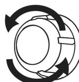
3. Ako je sijalica vaše rerne tipa (A) prikazana na donjoj slici, okrenite sijalicu rerne kao što je prikazano na slici i zamjenite je novom. Ako je model tipa (B), izvucite je kao što je prikazano na slici i zamjenite je novom.
