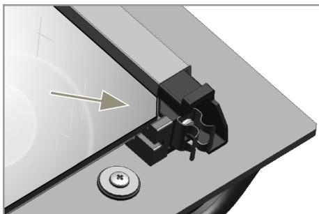
Prvi korak za vraćanje vrata u probitno stanje je vraćanje drugog i trećeg stakla (2, 3). Kao što je prikazano na slici, postavite zakošeni ugao staklene ploče tako da nalegne u zakošeni ugao na plastičnom prorezu.
