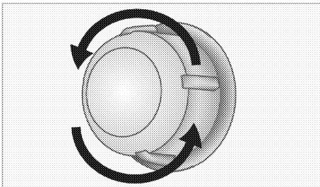
3. Ako lampa pećnice pripada tipu (A) kako je prikazano na slici ispod, uklonite je tako da je okrećete kako je prikazano i zamjenite je. Ako pripada tipu (B), povucite je i uklonite kako je prikazano na slici i zamjenite je.
