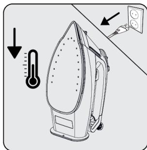
Ziehen Sie vor dem Reinigen den Netzstecker. Warten Sie, bis das Gerät vollständig abgekühlt ist.
