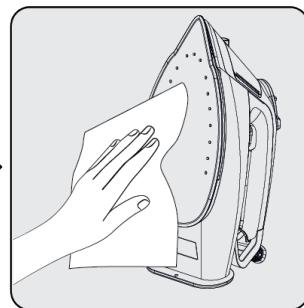
Essuyez les résidus éventuels qui se trouvent à l'extérieur de l'appareil et sur la semelle (9) en vous servant d'un chiffon humide et, le cas échéant, d'un produit de nettoyage liquide léger et non abrasif.
