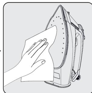
Cihazın dış kısmını ve tabanındaki (9) tortu ve kalıntıları hafif nemli bir bezle ve gereklise yumuşak, aşındırıcı olmayan bir sıvı temizleyici ile silin.
