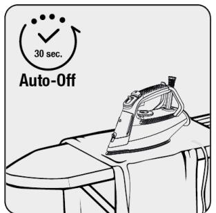
Si vous ne déplacez pas l'appareil pendant environ 30 secondes quand il est en position horizontale, il s'éteint automatiquement.
