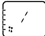
Trouba se nezahřívá. Funguje pouze ventilátor (v zadní stěně). Zmrzařené potraviny se rozmrazuje pomalu při pokojové teplotě, upečené potraviny se ochladí.
