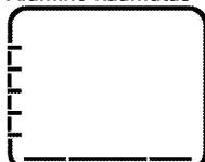
Töötab ainult alumine küttekeha. Sobib pitsa valmistamiseks ja toidu pruunistamiseks altpoolt.
