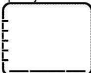
Darbojas tikai apakšējais sildelements. Tas ir piemērots picām un secīgai partikas apbrūnināšanai no apakšas.
