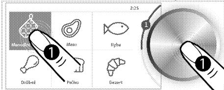
3. Jedním stisknutím ovládacího knoflíku trouby nebo stisknutím tlačítka „Ruční pečení“ na obrazovce získáte přístup k funkcím pečení.
