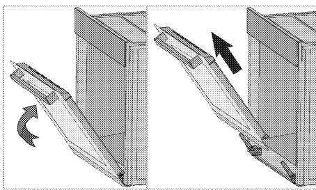
4. Demontujte přední dvířka tak, že je zatlačíte nahoru, pokud je chcete uvolnit z pravého a levého závěsu.
