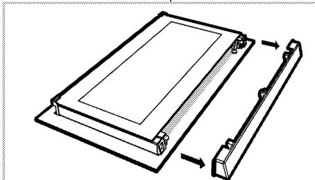
3. Podle obrázku zvedněte vnitřní skleněnou tabuli (1) ve směru A a vytáhněte ji ve směru B.
