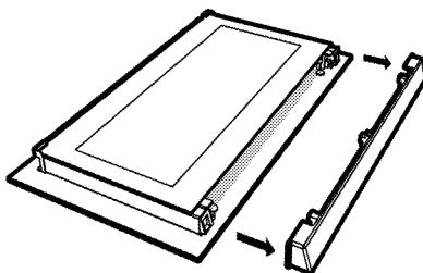
3. Såsom bilden visar ska du lyfta den innersta glaspalen något i riktning A och dra den ut i riktning B.
