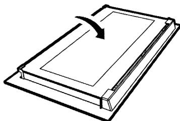
2. Dra mot dig och ta bort plastdelen som är installerad på den övre delen av den främre luckan.
