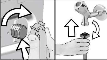
Nach dem Anschluss der Schläuche öffnen Sie die Wasserzuläufe (Hähne) komplett und überzeugen sich davon, dass kein Wasser an den Anschlussstellen austritt. Falls Wasser austreten sollte, drehen Sie den Hahn zu und lösen anschließend die Mutter. Überprüfen Sie die Dichtung, ziehen Sie die Mutter anschließend wieder gut an. Um ein Auslaufen von Wasser und daraus entstehende Wasserschäden zu vermeiden, halten Sie die Wasserhähne geschlossen, wenn Sie die Maschine nicht benutzen.
