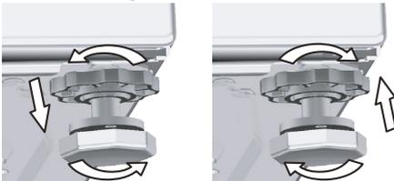
3 Ziehen Sie die Kontermuttern anschließend mit der Hand an.
