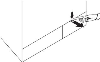
Bei einer einteiligen Filterkappe öffnen Sie die Kappe, indem Sie sie an beiden Seiten nach oben ziehen.
