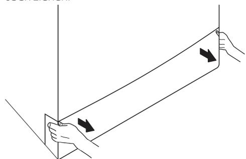
Die Filterabdeckung lässt sich entfernen, indem Sie einen dünnen Gegenstand mit Kunststoffspitze zur Hand nehmen und die Abdeckung durch die Öffnung oberhalb der Filterabdeckung etwas nach unten drücken. Versuchen Sie nicht, die Abdeckung mit Metallgegenständen zu lösen.
