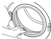
Falls die in der Abbildung gezeigten Öffnungen in der Gummidichtung verstopft sein sollten, entfernen Sie die Verstopfung mit einem Zahnstocher.
