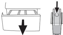
Drücken Sie die runde Markierung im Weichspülerfach hinab und ziehen Sie die Schublade zu sich hin, bis Sie sie aus der Maschine nehmen können.
