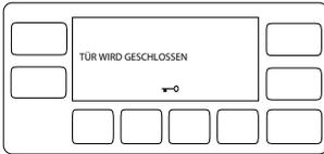
Ein spezielles Sicherungssystem verhindert das Öffnen der Tür, solange der Wasserpegel innerhalb der Maschine noch nicht als sicher gilt.
