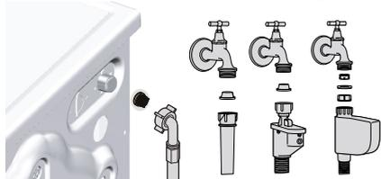
Am Endstück jedes Wasserzulaufventils an der Rückseite der Maschine sowie am Ende der Wasserzulaufschläuche (dort, wo diese an den Wasserhahn angeschlossen werden) befindet sich ein Filter. Diese Filter verhindern, dass Fremdkörper und Schmutz mit dem Wasser in die Waschmaschine gelangen. Die Filter sollten bei Verschmutzung gereinigt werden.
