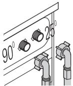
Schließen Sie die mit der Maschine gelieferten Spezialwasserzulaufschläuche an die Wasserzuläufe des Gerätes an. Der rote Schlauch (links) dient als Warmwassereinlass (maximal 90 °C), der blaue Schlauch (rechts) als Kaltwassereinlass (maximal 25 °C). Stellen Sie sicher, dass Heiß- und Kaltwasserhähne bei Installation des Produktes richtig angeschlossen werden. Bei fehlerhaftem Anschluss kommt Ihre Wäsche am Ende des Waschvorgangs eventuell heiß aus der Maschine und verschleißt schneller.
