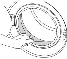
Achten Sie nach jeder Wäsche darauf, dass keine Fremdkörper in der Trommel zurückbleiben. Falls die in der Abbildung gezeigten Öffnungen in der Gummidichtung verstopft sein sollten, entfernen Sie die Verstopfung mit einem Zahnstocher. Metallische Objekte können Rostflecken in der Trommel verursachen. Reinigen Sie die Trommel mit einem Edelstahlreiniger. Verwenden Sie niemals Stahlwolle. Solche Mittel beschädigen lackierte, chromatierte Flächen und Kunststoffteile.
