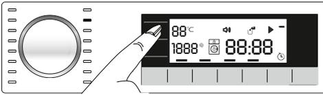
Drücken Sie zum Ändern der Temperatur die **Temperatureinstelltaste**. Die Temperatur verringert sich schrittweise um 10 °C. Abschließend erscheint das Symbol „-“ im Display und zeigt die Kaltwäsche-Option an.
