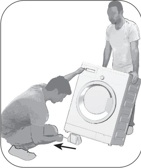
Zum Entfernen der Transportstabilisatoren neigen Sie die Maschine etwas nach hinten. Entfernen Sie die Stabilisatoren durch Ziehen am Band. Führen Sie diese Arbeit nicht alleine durch.
