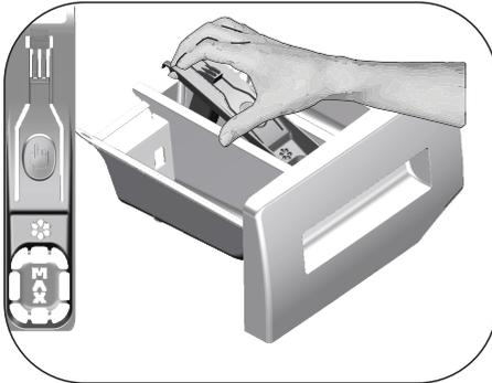
Reinigen Sie die Waschmittelschublade regelmäßig (jeweils nach 4 – 5 Wäschen), damit sich im Laufe der Zeit keine Waschmittelreste ansammeln. Gehen Sie dazu wie folgt vor: Heben Sie den Siphon wie abgebildet am hinteren Teil an und heraus.
