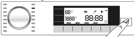
**Falls der Wasserstand** in der Maschine bei Betätigung der Start/Pause-Taste zu hoch ist, bleibt das Türsymbol im Display.
