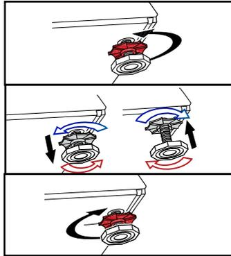
1. Lösen Sie die Kontermuttern an den FüÙen von Hand.
