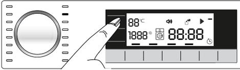
Drücken Sie zum Ändern der Temperatur die **Temperatureinstelltaste**. Die Temperatur verringert sich schrittweise um 10 °C. Abschließend erscheint das Symbol „-“ im Display und zeigt die Kaltwäsche-Option an.
