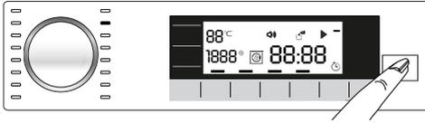
4 Die Programmfolgeanzeigen im Display zeigen den aktuellen Programmschritt.
