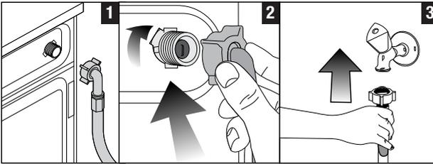
1. Schließen Sie die mit der Maschine gelieferten Spezialwasserzulaufschläuche an die Wasserzulaufe des Gerätes an. Der rote Schlauch (links) dient als Warmwassereinlass (maximal 90 °C), der blaue Schlauch (rechts) als Kaltwassereinlass (maximal 25 °C).
