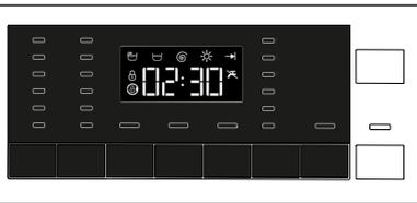
Das Programm wird abgebrochen, wenn die Maschine aus- und wieder eingeschaltet wird. Drücken Sie die Taste **Ein / Aus** und halten sie 3 Sekunden lang gedrückt. Nach Ablauf des Countdowns („3-2-1“) im Display schaltet sich die Maschine aus.
