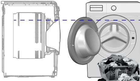
Bei dem Programm 5 kg waschen & 5 kg trocknen sollte die Maschine zur Erzielung optimaler Trocknungsbedingungen nicht über die in der obigen Abbildung gezeigten Markierung hinaus beladen werden (wenn die Tür der Maschine geöffnet ist, sehen Sie eine Pfeilmarkierung).
