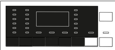
Wenn Sie den Waschvorgang erst später beginnen lassen möchten, können Sie den Programmstart durch die **Endzeit**-Funktion um bis zu 24 Stunden hinausschieben. Nach Betätigung der **Endzeit**-Taste wird die geschätzte Endzeit des Programmes angezeigt. Wenn die **Endzeit** angepasst wird, leuchtet die **Endzeit**leuchte.
