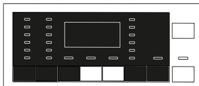
**Halten Sie die 2. und 3. Zusatzfunktionstaste gemeinsam 3 Sekunden lang gedrückt.** Nach Ablauf des Countdowns („Kindersicherung 3-2-1“) im Display wird „Kindersicherung aktiviert“ angezeigt. Sie können die **2. und 3. Zusatzfunktionstaste** loslassen, wenn diese Warnung angezeigt wird.
