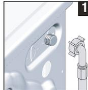
**1** Schließen Sie den mit der Maschine gelieferten Spezialschlauch an den Wasserzulauf des Gerätes an.
