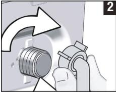
**2** Ziehen Sie die Muttern des Schlauches sicher von Hand fest. Ziehen Sie die Muttern niemals mit einem Werkzeugen an.
