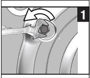
**1** Lösen Sie sämtliche Bolzen mit dem Werkzeug, bis sie sich frei drehen lassen.
