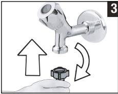
**3** Nach dem Anschluss der Schläuche öffnen Sie die Wasserzuläufe (Hähne) komplett; überzeugen Sie sich davon, dass kein Wasser an den Anschlussstellen austritt.
