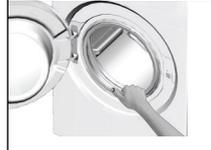
Achten Sie nach jeder Wäsche oder Trocknung darauf, dass keine Fremdkörper in der Trommel zurückbleiben. Falls die in der Abbildung gezeigten Öffnungen in der Gummidichtung verstopft sein sollten, entfernen Sie die Verstopfung mit einem Zahnstocher.
