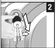
**2** Entfernen Sie die Transportsicherungen, indem Sie diese vorsichtig herausdrehen.
