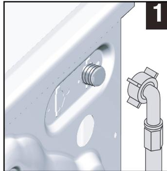
**1** Schließen Sie den mit der Maschine gelieferten Spezi­schlauch an den Wasserzulauf des Gerätes an.
