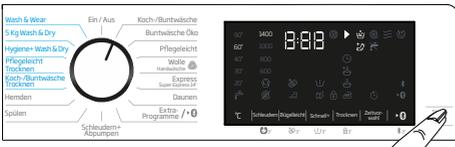
Halten Sie die Maschine durch Drücken der **Start/Pause**-Taste an.
