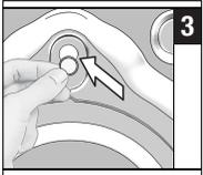
**3** Setzen Sie die Kunststoffabdeckungen (diese finden Sie in der Tüte mit der Bedienungsanleitung) in die Löcher an der Rückwand ein.
