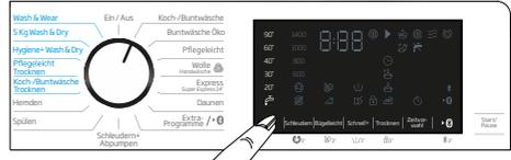
Sobald Sie ein neues Programm auswählen, wird die für das jeweilige Programm empfohlene Waschtemperatur in der Temperaturanzeige angezeigt. Möglicherweise ist die empfohlene Temperatur nicht die Maximaltemperatur, die beim entsprechenden Programm ausgewählt werden kann. Drücken Sie zum Ändern der Temperatur die **Temperatureinstelltaste**.
