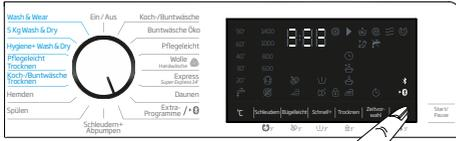
Bei aktivierter Bluetooth können Sie die Maschine am Gerät selbst nur abschalten und ihren aktuellen Status verfolgen. Alle sonstigen Funktionen mit Ausnahme der Kindersicherung steuern Sie über die Applikation.
