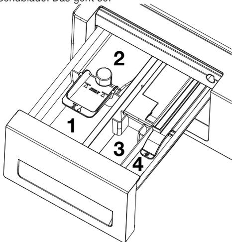
1. Zum Entnehmen ziehen Sie die Waschmittelschublade mit etwas Kraft zu sich hin heraus.
