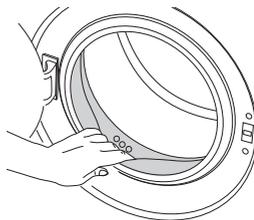
Falls die in der Abbildung gezeigten Öffnungen in der Gummidichtung verstopft sein sollten, entfernen Sie die Verstopfung mit einem Zahnstocher.
