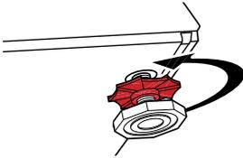
2 Stellen Sie die FüÙe so ein, dass das Gerät stabil und absolut gerade steht.
