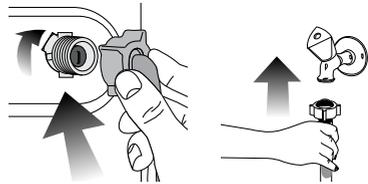
3 Nach dem Anschluss der Schläuche öffnen Sie die Wasserzuläufe (Hähne) komplett und überzeugen sich davon, dass kein Wasser an den Anschlussstellen austritt. Falls Wasser austreten sollte, drehen Sie den Hahn zu und lösen anschließend die Mutter. Überprüfen Sie die Dichtung, ziehen Sie die Mutter anschließend wieder gut an. Um ein Auslaufen von Wasser und daraus entstehende Wasserschäden zu vermeiden, halten Sie die Wasserhähne geschlossen, wenn Sie die Maschine nicht benutzen.
