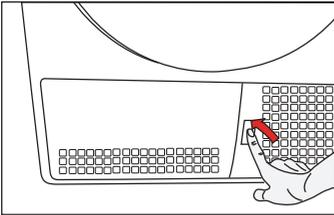
2. Öffnen Sie die Frontblende und lösen Sie die beiden Kondensatorsperren.
