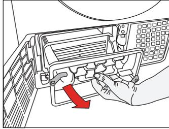
4. Reinigen Sie den Kondensator unter einem kräftigen Wasserstrahl (z. B. mit dem Duschkopf), lassen Sie das Wasser komplett ablaufen.
