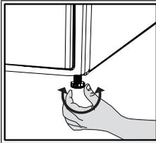
Stellen Sie die Ständer ein, indem Sie sie nach links und rechts drehen, bis der Trockner waagrecht und stabil steht.
