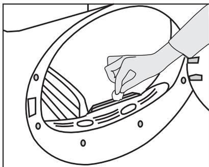
Wenn sich im Trichter des Wassertanks Fasern angesammelt haben, entfernen Sie diese unter fließendem Wasser.
