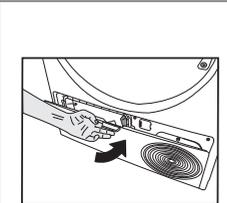
Setzen Sie nach Abschluss des Reinigungsvorgangs die Luftleitblechabdeckung an ihren Platz, bewegen Sie die Riegel, um sie zu schließen, und schließen Sie das Bordbrett.
