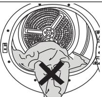
Stellen Sie sicher, dass sich keine Wäsche an der Ladeklappe eingeklemmt ist.
