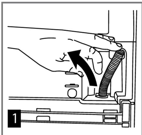
Schließen Sie ein Ende des gelieferten Abflussschlauches an der Stelle an, an der Sie den Schlauch im letzten Schritt entfernt haben.
