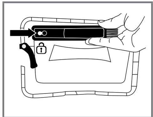
Setzen Sie nach Abschluss des Reinigungsvorgangs die Luftleitblechabdeckung an ihren Platz, bewegen Sie die Riegel, um sie zu schließen, und schließen Sie die Kondensatorabdeckung.
