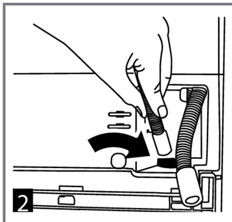
Verbinden Sie das andere Ende des Wasserabflussschlauches direkt mit dem Abfluss in der Wand oder am Waschbecken.
