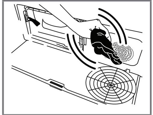
Belasten Sie die Kondensatorabdeckung nicht, wenn sie geöffnet ist.
