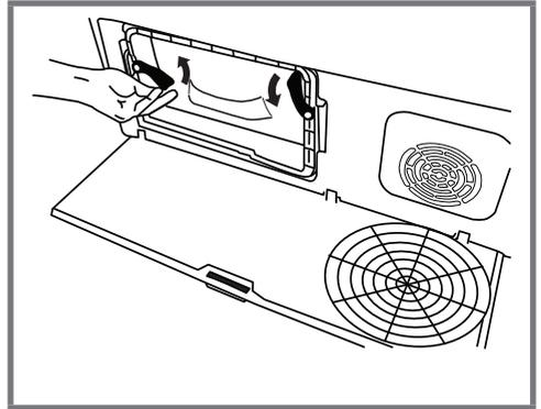
Ziehen Sie die Bürste nach links, um sie zu entfernen. Mit der Reinigungsbürste können Sie Filter, kondensierende Metalloberfläche und angesammelte Fasern an der Gerätetür reinigen.
