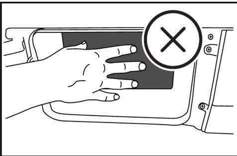
**i** Wenn die Luftleitblechabdeckung entfernt wird, befindet sich normalerweise Wasser am Kunststoffabschnitt vor dem Kondensator.
