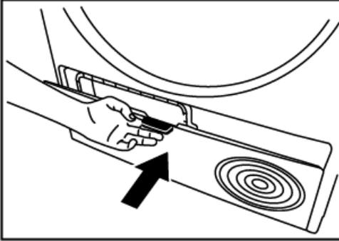
**i** Sie können von der Hand reinigen, sofern Sie Schutzhandschuhe tragen. Versuchen Sie nicht, mit bloßen Händen zu reinigen. Die Kondensatorlamellen können Ihre Hände verletzen. Die Reinigung von links nach rechts kann die Kondensatorlamellen beschädigen. Dies kann zu Trocknungsproblemen führen.
