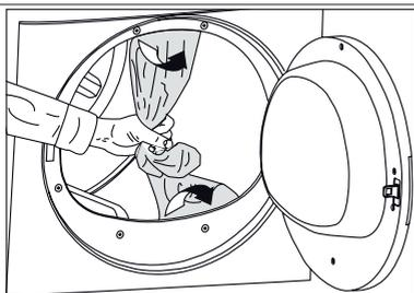
Entfernen Sie die Transportsicherungen, bevor Sie das Gerät zum ersten Mal benutzen. Wenn der Türanschlag bei Ihrem Gerät wechselbar ist, lesen Sie die Montageanleitung für den Türanschlagwechsel durch, die mit Ihrem Gerät geliefert wurde.
