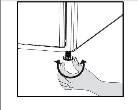
Stellen Sie die FüÙe (durch Drehen) so ein, dass der Trockner absolut gerade steht und nicht wackelt.
