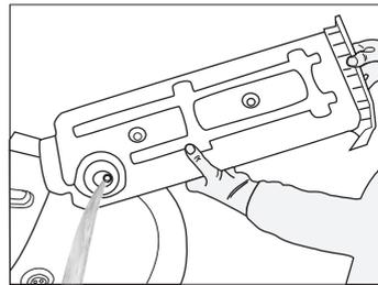
3. Falls sich Fusseln im Trichter des Wassertanks angesammelt haben sollten, entfernen Sie diese unter fließendem Wasser.
