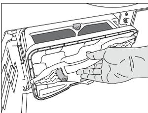
4. Öffnen Sie die Filterschublade durch Drücken des roten Knopfes.
